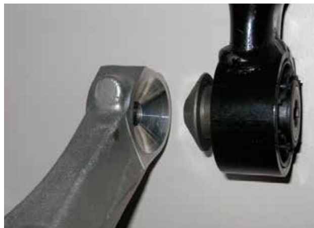
图1.装配前,采用锥形接合的止推杆(黑色)和后转向(银色)特写图。
